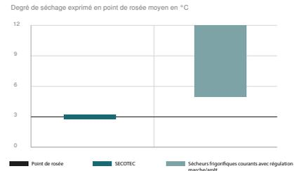
Grâce à leur grande capacité d'accumulation, les sècheurs frigorifiques SECOTEC sont très respectueux du matériel. Lorsque l'accumulateur frigorifique est chargé, le compresseur frigorifique et le ventilateur peuvent rester à l'arrêt pendant beaucoup plus longtemps sans nuire à la stabilité du point de rosée.
