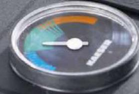
Charge du sécheur frigorifique
