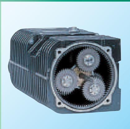
Amélioration de la compacité du palan. Faible niveau de bruit pendant l'utilisation grâce à sa pignonerie lubrifiée par bain de graisse et sa denture droite rectifiée et traitée.
