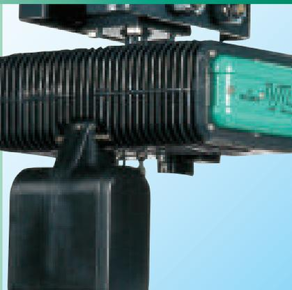
En aluminium moulé injecté contribuant à l'allègement du palan, les ailettes de la partie moteur assurent un bon échange thermique. Le châssis reçoit une couche de peinture époxy biocomposant de 80 microns d'épaisseur offrant une grande résistance à la corrosion.
