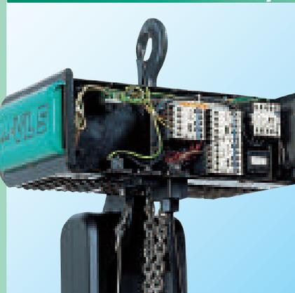
De grande dimension, intégré à l'appareil, il renferme l'ensemble des composants (platine, contacteurs, transformateur,...) et offre un accès aisé pour toute action de maintenance, protection IP55.
